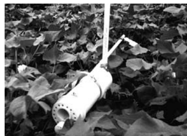
Figura 1. Conjunto sensor: psicrômetro aspirado e sensor de DPM, instalado na cultura do algodoeiro.
