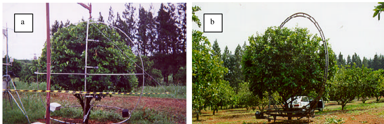
Figura 1. Vista das árvores utilizadas com o sistema móvel de medida do balanço de radiação. (a) árvore cujos resultados são apresentados neste trabalho. (b) árvore com o novo sistema móvel (ainda sem os saldo-radiômetros) a ser utilizado futuramente.
