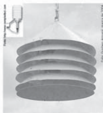
Figura 1. O abrigo meteorológico de baixo custo (Abc) em evidência, e uma representação esquemática do abrigo de Campbell acima e a esquerda.
